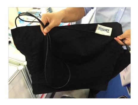
美国传感器公司[]SENSORPRODUCTSINC.[]的床垫式柔性织物压力分布采集系统Bodyfitter-
